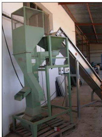
FOTO N° 11: Aventadora separadora de pistachos vacíos y llenos
