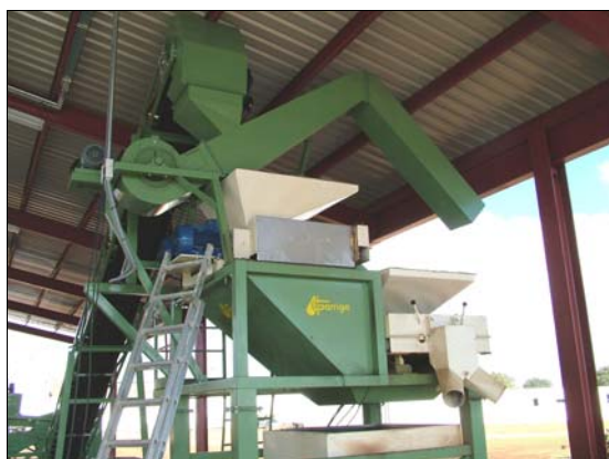
FOTO N° 7: Peladoras en serie de pistachos
