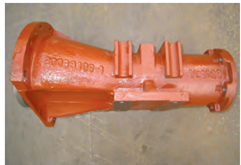
Carcasa eje trasero. Realizado en fundición gris.
