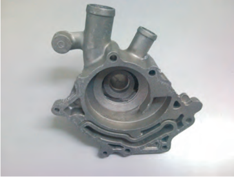
carcasa de turbo realizada en fundición de aluminio por gravedad
