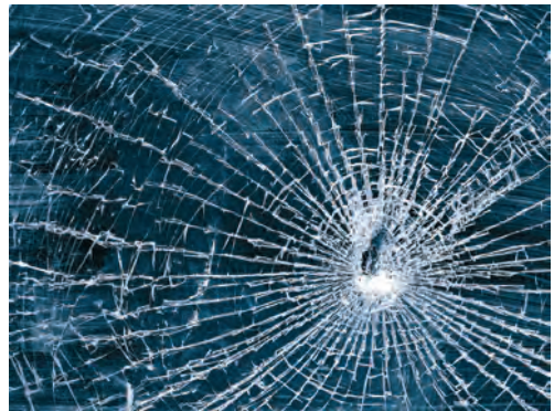
Rotura de un vidrio laminado.
