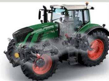
Fendt ofrece mayor potencia y eficiencia con el sistema VarioGrip para la regulación de la presión de los neumáticos. El sistema permite que la presión del neumático se regule durante la conducción. Sus ventajas:
